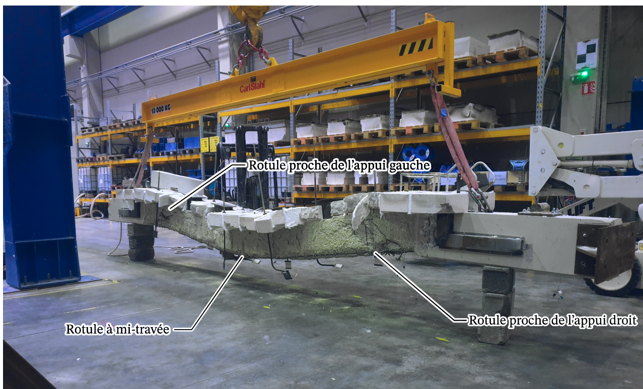
FIG. 5.23. : Corps d'épreuve à sa sortie du four six jours après l'essai, on peut remarquer le changement de l'état de surface dû à l'avancement de la réhydratation du béton par rapport à la figure 5.22.
