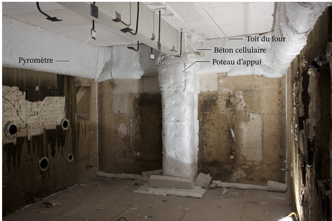
FIG. 5.14. : Vue de l'intérieur du four avant le démarrage de l'essai.
