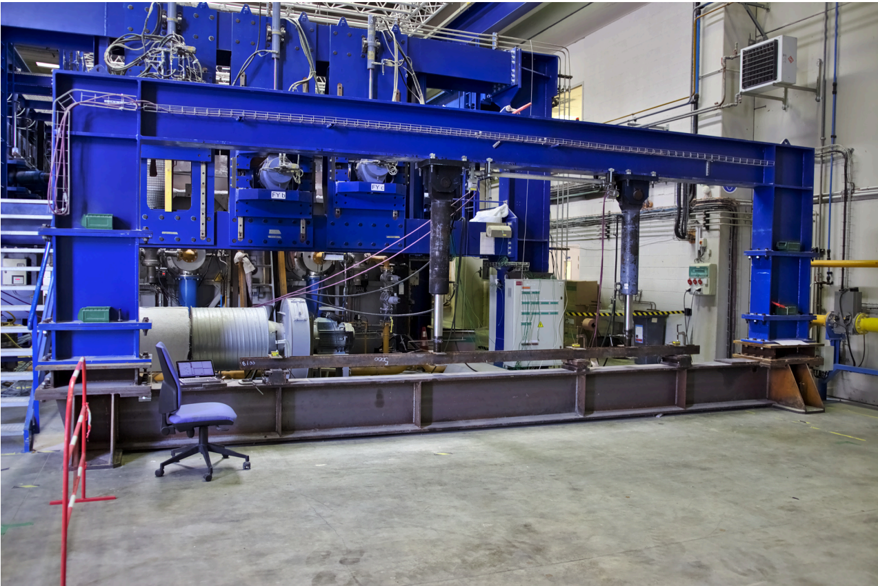
FIG. 4.27. : Montage expérimental de l'essai hybride à température ambiante inverse sur une poutre en acier.
