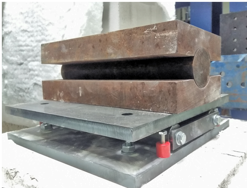
FIG. 5.8. : Pivot glissant de l'appui 1.
