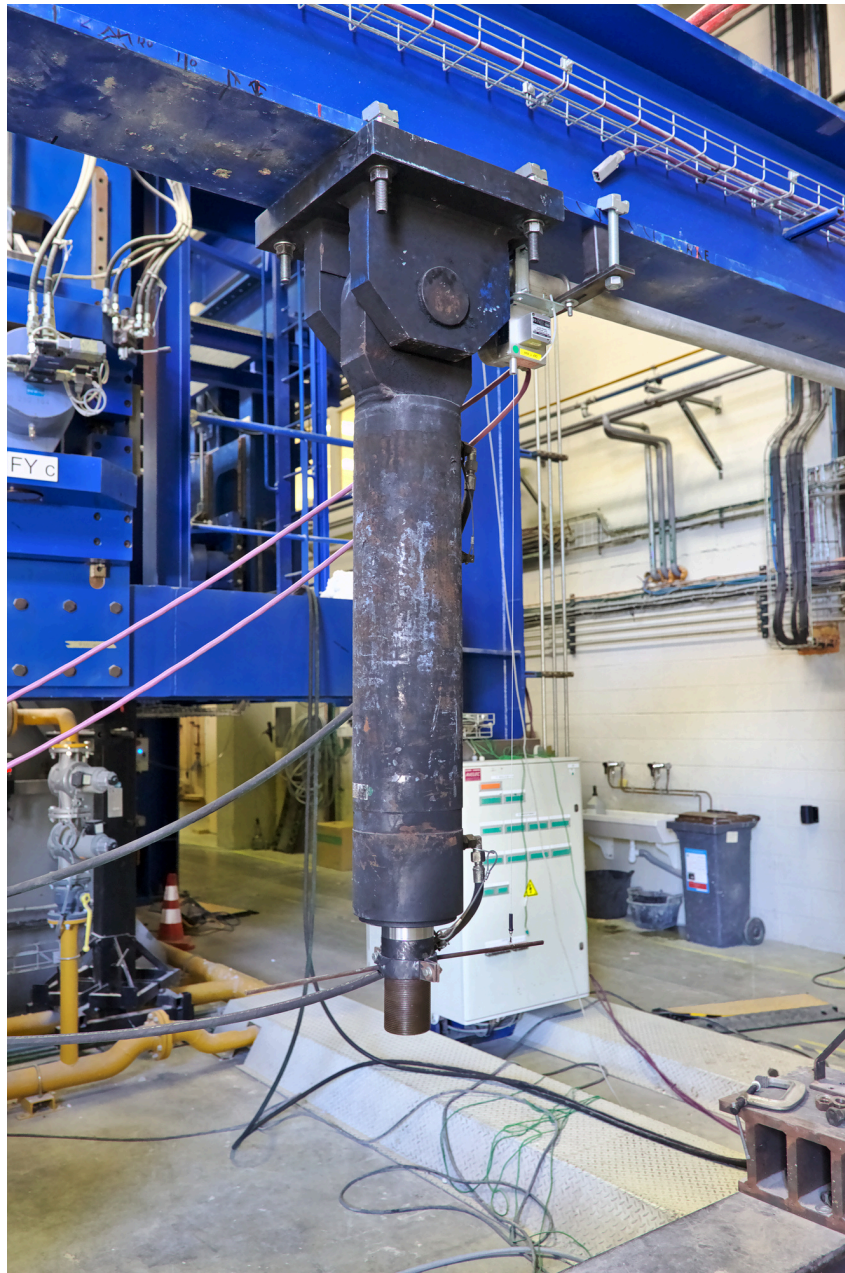
FIG. 4.9. : Vue du vérin vertical 1 ainsi que du capteur de déplacement.
