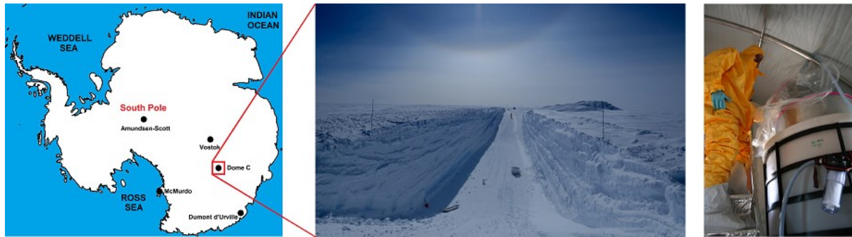
Figure A : position géographique du Dôme C en Antarctique (gauche) ; image d'une tranchée creusée pour l'extraction de micrométéorites à Dôme C (milieu) ; fondoir utilisé pour la fonte des neiges antarctiques et la collecte de micrométéorites.
