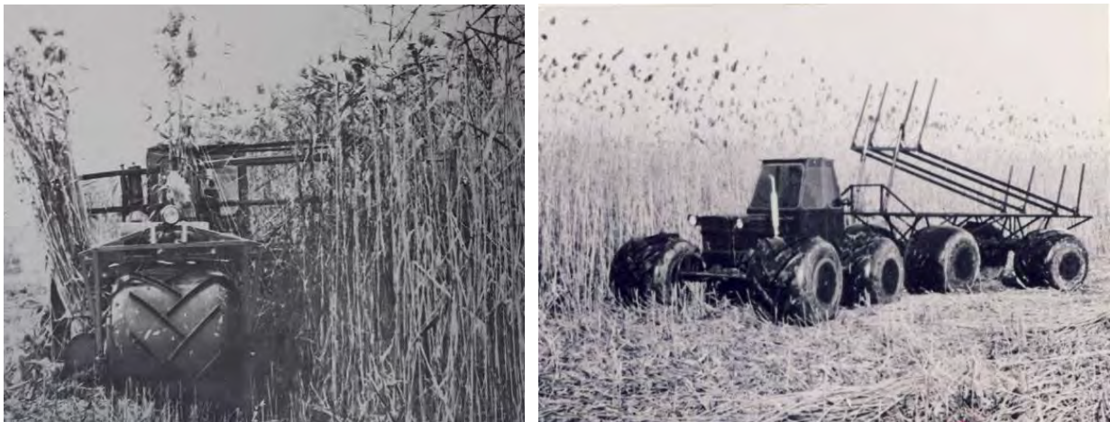
Fig.14.7 Engins équipés de grands pneus à basse pression pour l'exploitation du roseau Source : Motoc, 2016
