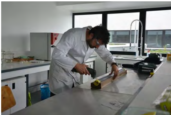
a. Ouverture carotte à la scie électrique
