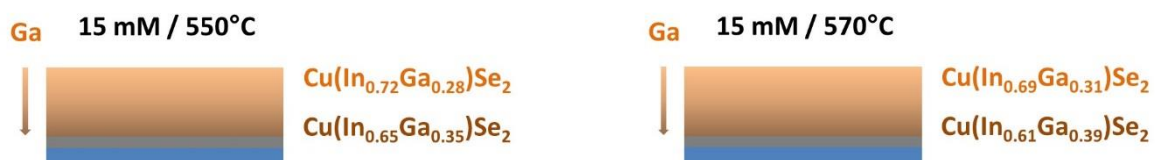
Figure IV-44 : Schéma explicatif de l'effet de l'augmentation de la température de sélénisation sur la formation d'un absorbeur CIGS d'un précurseur 15 mM.
