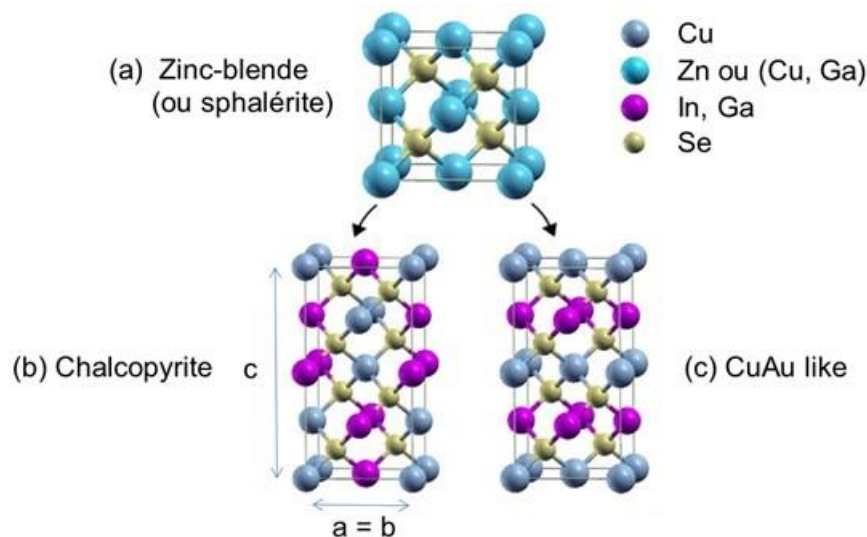
Figure I-16 : Structure cristalline de (a) blende de zinc ZnS (ou sphalérite dans le cas d'une substitution de Zn par du (Cu, Ga)), (b) chalcopyrite \text{CuGaS}_2 et (c) Cu-Au pour \text{CuGaS}_2 [52].
