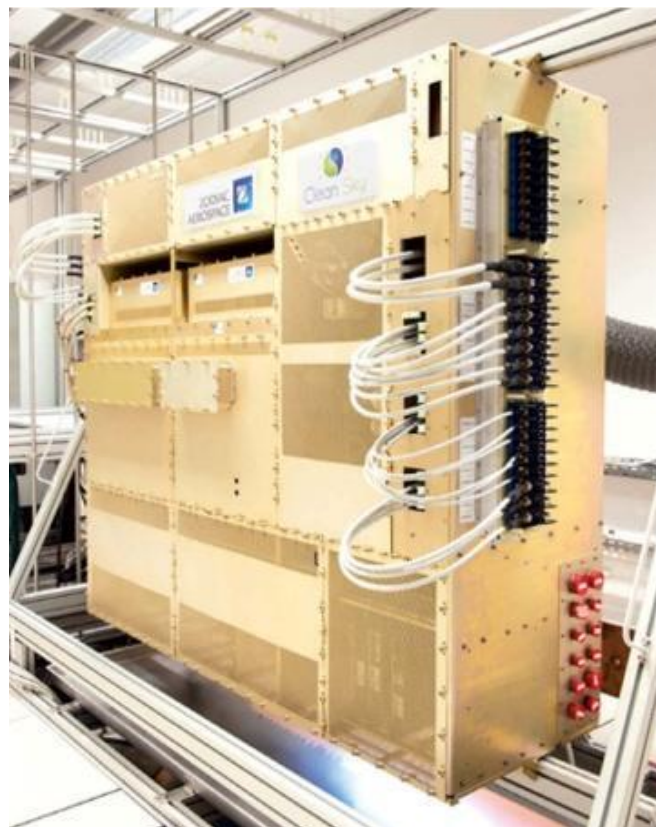
Figure 37 : Boîtier de distribution électrique
