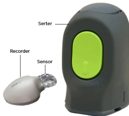
Figure 34. Composition du CGMS IPro®2 de Medtronic, d'après [5].
