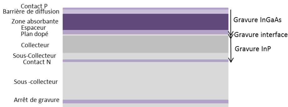
Figure 38: Couches de semiconducteurs gravées pendant la gravure humide.
