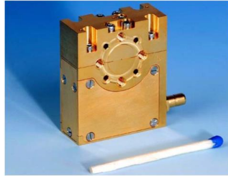
Module LNA à 600 GHz
