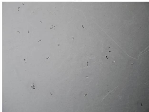
FIGURE B.3 – Vue microscopique des morceaux de fils libérés.
