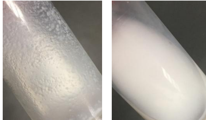
Figure 34. Photographies de la suspension de NP-CLR avec un taux de chargement de 1% montrant l'aspect obtenu après évaporation des solvants lorsque la phase aqueuse est composée d'eau (à gauche) ou de bicarbonate 5 mM (à droite)
