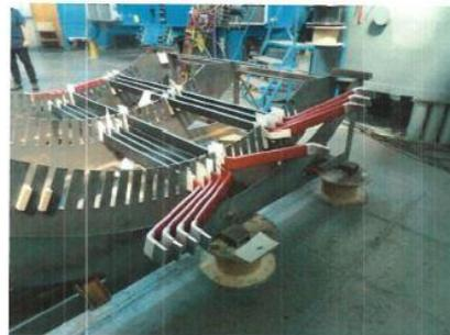
Figure 5-7. Montages des barres de stator (Velo, 1990)
