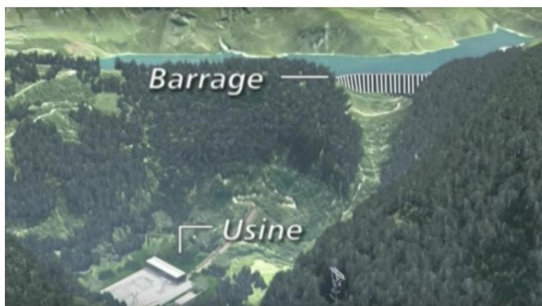
Figure 2-4. Exemple d'une centrale de lac (Source : EDF)
