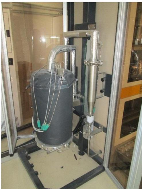
**Figure II.7 : Chlorureur d'Aluminium, permettant la formation du précurseur  $AlCl_{3(g)}$ .**
