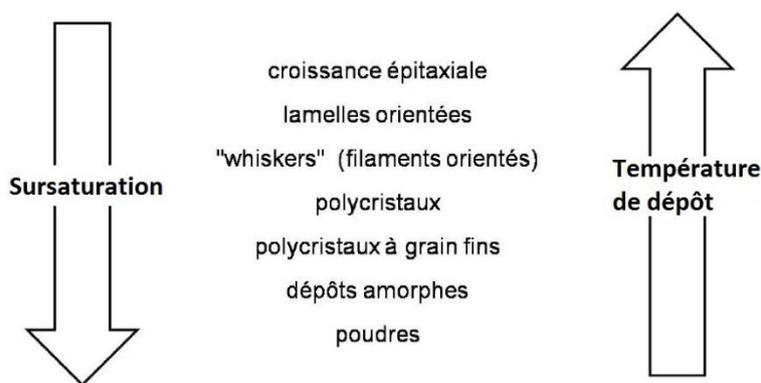
**Figure I.6 : Microstructures obtenues en fonction des paramètres température de dépôt et sursaturation [3].**
