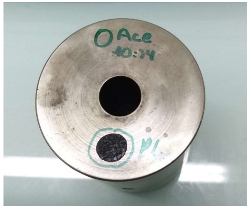
Figure IV-43 : Résultat des essais de compatibilité acier/acide pour l'acide acétique (haut) et l'acide phosphorique (bas)
