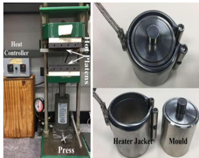
Figure I-27 : Montage CSP utilisé par Clive Randall à la PennState University
