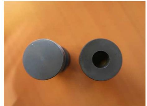
FIGURE II.1 – Lanceur Pyrène (gauche) et photographie des sabots utilisés de diamètre 32 mm (droite) : sabot standard et allégé
