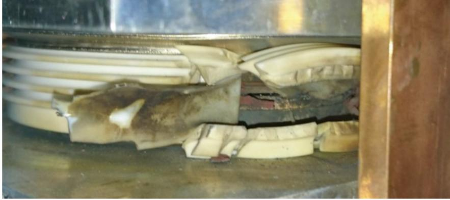
Figure II.2: Diode explosée à cause d'un trop fort  $di/dt$  [15].
