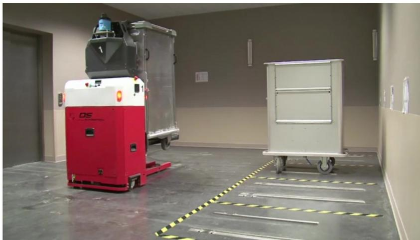
FIGURE 1.5 – Véhicules à guidage automatique
