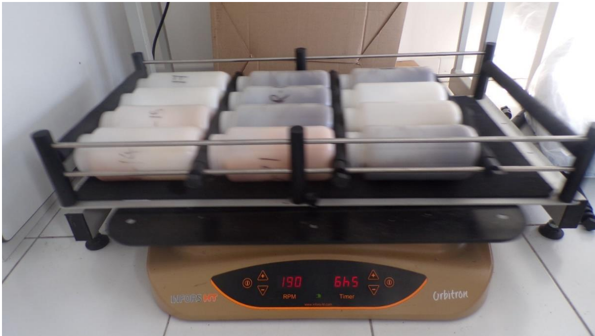
Fig. A1.1. Agitation des échantillons de carbonate prélevés au cap Laundi (Sumba, Indonésie). Agitateur du C.E.R.E.G.E..
