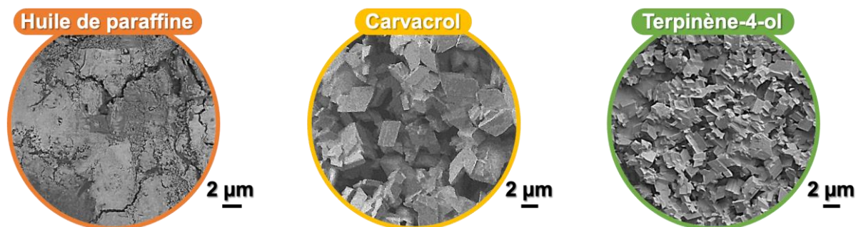
Figure 3.8 : Morphologie des complexes d'inclusion \beta -CD/huile sous observation sèche au MEB
