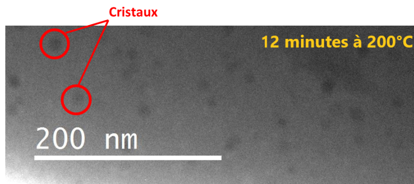
FIGURE 4.8 – Image MET champ clair de l'échantillon amorphe cristallisé in situ en MET à 200^{\circ}\text{C} pendant 12 minutes.
