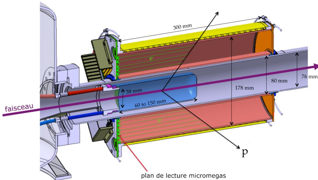
FIGURE 2.5 – Vue schématique de la cible de dihydrogène liquide MINOS couplée à une chambre à projection temporelle, avec une réaction (p,2p), les deux protons issus du vertex produisent des électrons de dérive le long de leur trajectoire au sein de la TPC.
