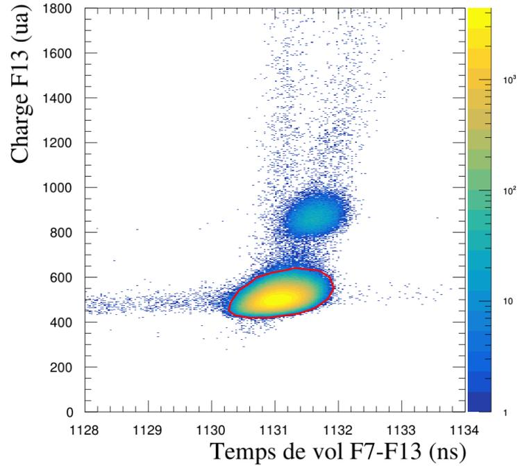
FIGURE 4.25 – Charge déposée dans les plastiques en F13 en fonction du temps de vol du faisceau mesuré entre F7 et F13. Le faisceau est purement composé d' $^8\text{He}$ , le groupe de points secondaire représente une petite partie du faisceau qui a perdu davantage d'énergie en traversant plus de matériaux entre F3 et F13. La coupure utilisée ne sélectionnant que les bons événements est représentée en rouge.
