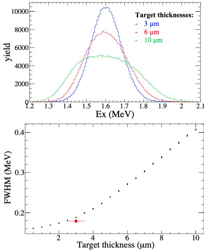
FIGURE 3.2 – En haut, spectre en excitation d'énergie reconstruite pour 3 épaisseurs de cible différentes pour la réaction  $^{19}\text{O}(d,p)^{20}\text{O}$  peuplant l'état  $2+$  à 1,67 MeV. En bas, évolution de la résolution sur l'énergie d'excitation en fonction de l'épaisseur de cible. Le carré rouge représente la valeur expérimentale.
