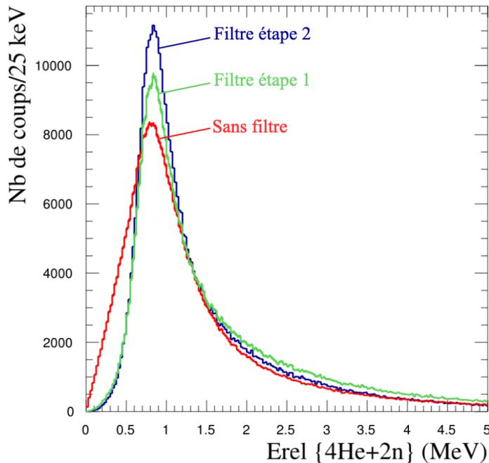
Figure 4.34 – Spectre en énergie relative du système  ${}^4\text{He}+2n$  pour différentes étapes du filtre de diaphonie. Sans filtre (ligne rouge), à la suite de l'étape 1 du filtre (ligne verte), après l'étape 2 (ligne bleu). L'intégrale des spectres a été normalisée sur celle du spectre bleu avec le filtre complet.
