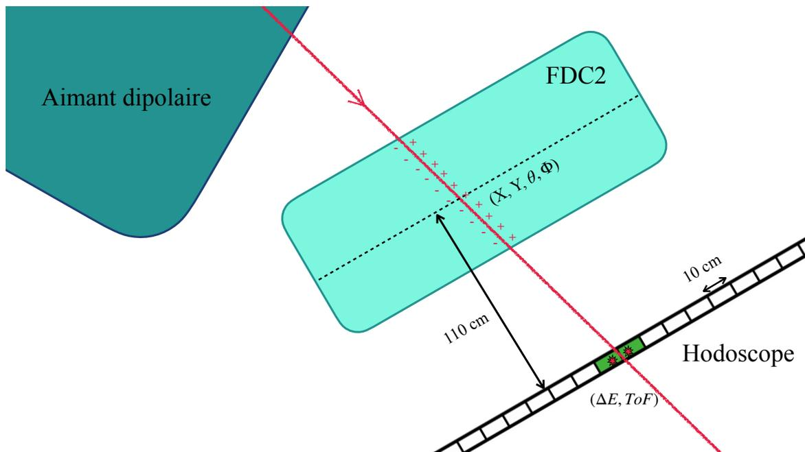
FIGURE 4.14 – Schéma de la disposition des détecteurs FDC2 et Hodoscope avec l'aimant. La ligne rouge représente le passage d'un ion à l'interface entre les deux lattes de l'hodoscope produisant deux signaux contigus, ces types d'événements sont utilisés pour reproduire le spectre fig.4.15. Par soucis de visibilité les proportions n'ont pas été respectées.
