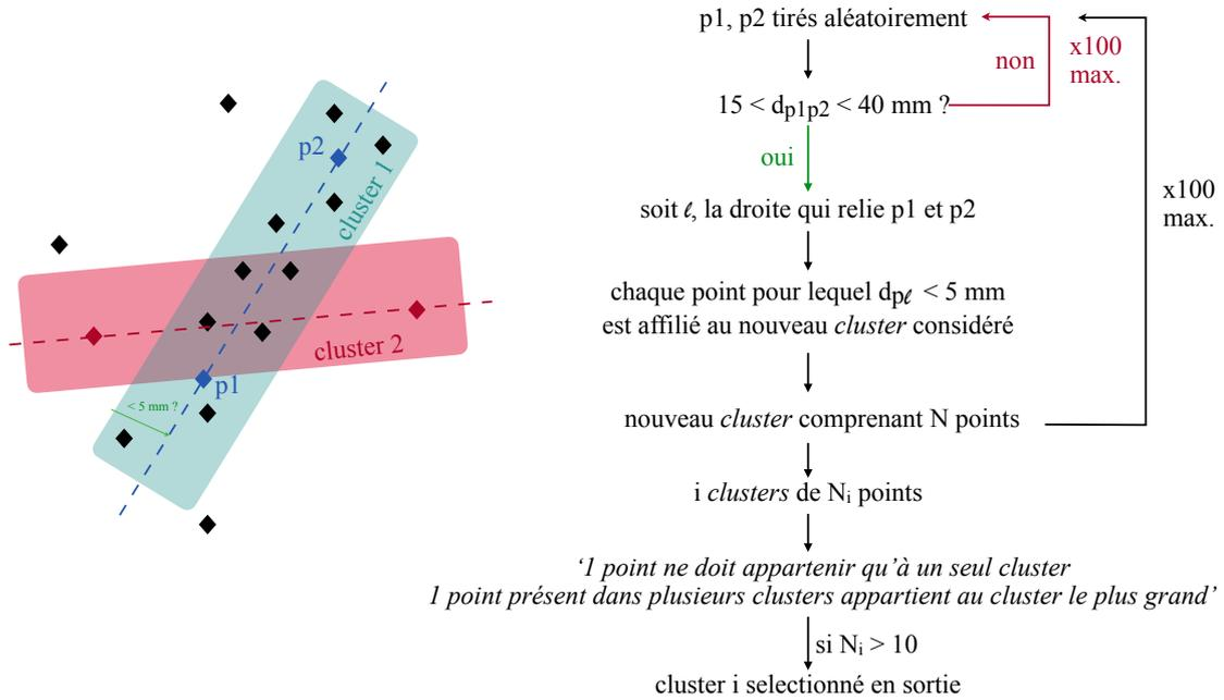
FIGURE 3.8 – Représentation schématique du principe de l’algorithme RANSAC appliqué à la reconstruction de traces linéaires. Le dessin de gauche présente le cas simple d’une trace en deux dimensions, avec deux exemples de *clusters* testés. Les étapes de l’algorithme détaillées ici sont transposables en trois dimensions, et les paramètres sont ceux adaptés à la TPC de MINOS. Le code dans lequel s’inscrit cet algorithme est accessible dans *nptool* [89].
