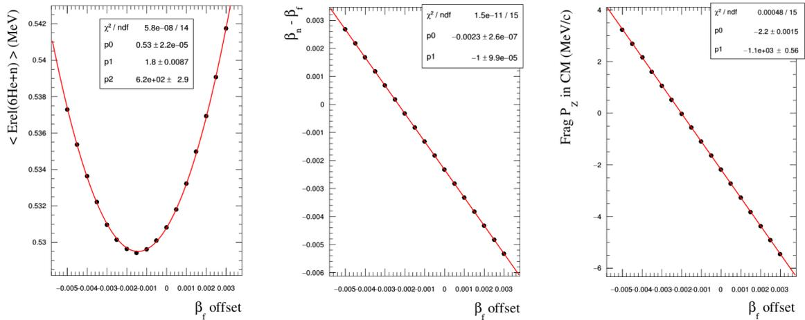
FIGURE 4.28 – Résultats utilisés pour l'alignement de la vitesse ( $\beta = \frac{v}{c}$ ) des fragments  ${}^6\text{He}$  sur celle du neutron issue de la voie de réaction  ${}^8\text{He}(p,pn){}^6\text{He}+n$  (voir texte). De gauche à droite, moyenne de l'énergie relative du système ( ${}^6\text{He}+n$ ) en fonction du décalage appliqué sur  $\beta_f$ , de même avec la différence entre les vitesses neutron et fragment puis avec l'impulsion suivant Z du fragment dans le centre de masse.
