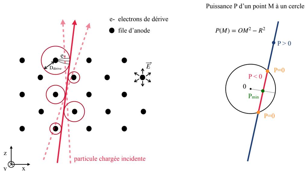
FIGURE 4.9 – Schéma du principe de reconstruction de traces dans les chambres à dérive. À gauche, représentation simplifiée d'un plan de fils vu du dessus, avec une trace et les cercles de dérive en rouge (voir texte). À droite, schéma représentant la puissance d'un point  $M$ , le long d'une droite, à un cercle dans le cas où la droite traverse le cercle.
