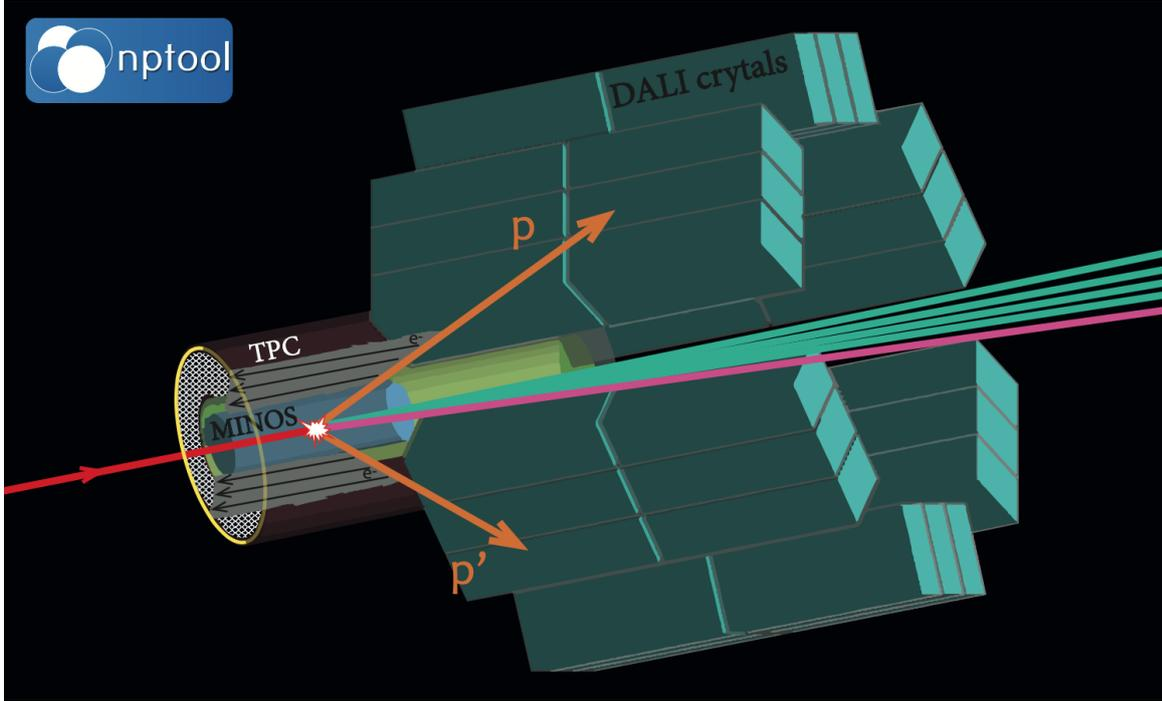
FIGURE 3.3 – Simulation GEANT4 de l'ensemble cible-détecteurs MINOS-TPC+DALI2 dans la configuration employée pour l'expérience S034. Cette simulation a été réalisée avec *nptool*, une réaction  ${}^8\text{He}(p,2p){}^7\text{H}$  est schématisée avec les neutrons représentés en vert et le triton en rose.
