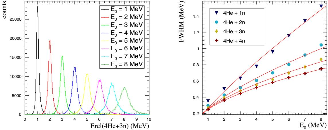
FIGURE 3.12 – Évolution de la résolution pour différents pics de résonances étroites simulées pour un système  ${}^4\text{He} + 3\text{n}$  à 156,5 MeV/N. À droite, résolution en fonction de l'énergie relative pour différents systèmes  ${}^4\text{He} + 1\text{n}$ ,  $2\text{n}$ ,  $3\text{n}$  et  $4\text{n}$ .
