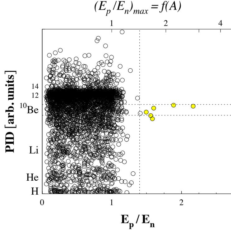
FIGURE 1.7 – Rapport entre l'énergie de recul d'un proton dans les scintillateurs et l'énergie incidente  $E_p/E_n$  mesurée, en fonction de la particule chargée identifiée en coïncidence pour des réactions ( $^{14}\text{Be}, X + n$ ). L'axe du haut représente la limite maximale  $E_p/E_n$  pour un système multineutron en fonction de son nombre de masse  $A$ . Les événements en jaunes sont les candidats à la formation de tétraneutrons. Figure reproduite de la référence [5], adaptée de [6].
