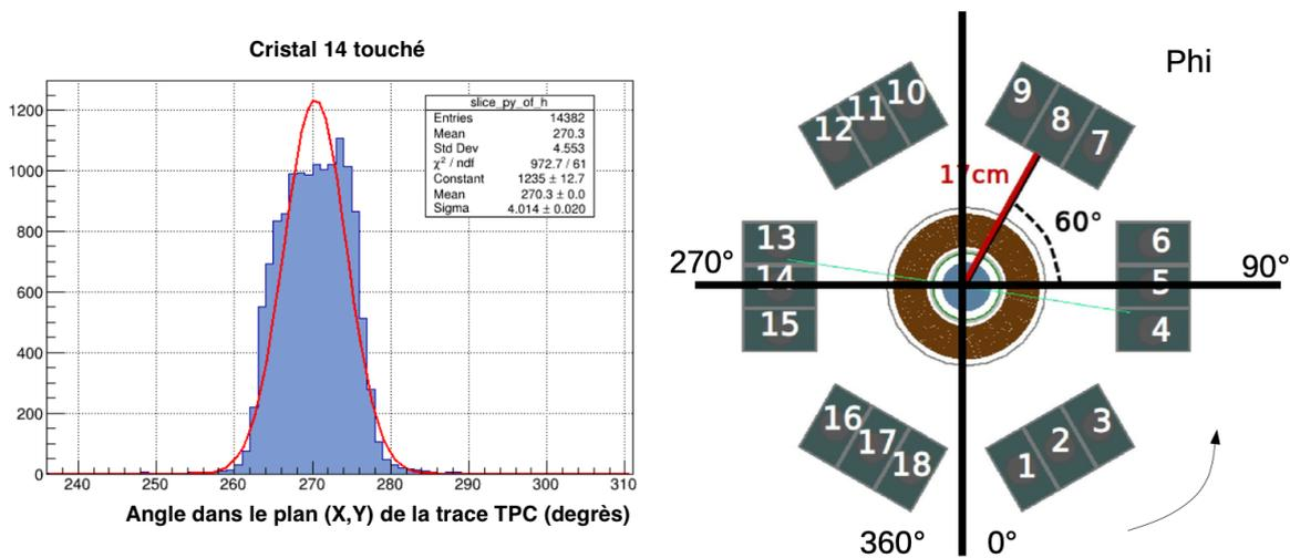
FIGURE 4.7 – À droite, schéma représentant MINOS-TPC vu de dos surmonté des cristaux numérotés de 1 à 18 du premier anneau de DALI. À gauche, distribution de l'angle azimutale (dans le plan  $X,Y$ ) de la trace dans MINOS-TPC lorsque la particule touche le cristal 14.
