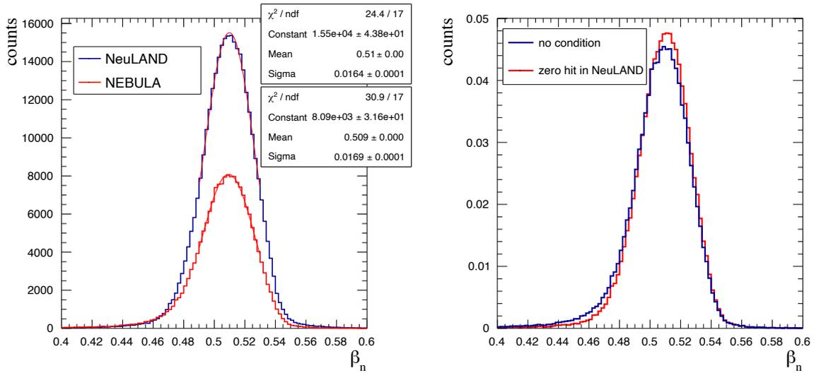
FIGURE 4.24 – À gauche : vitesse  $\beta = \frac{v}{c}$  des neutrons issus de la voie de réaction  ${}^8\text{He}(p,pn){}^6\text{He}+n$  mesurée par NeuLAND (ligne bleu) et NEBULA (ligne rouge). À droite, effet de la détection dans NeuLAND sur la  $\beta_n$  dans NEBULA pour la voie  $1n$ .
