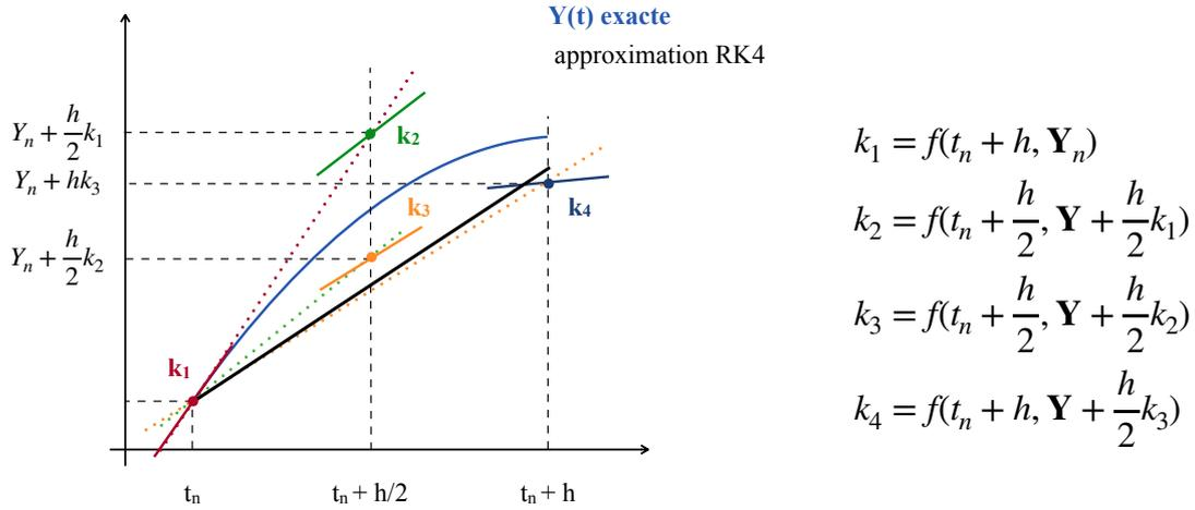
FIGURE 4.11 – Schéma du principe général de la méthode Runge-Kutta d'ordre 4 pour une fonction quelconque  $Y(t)$ .
