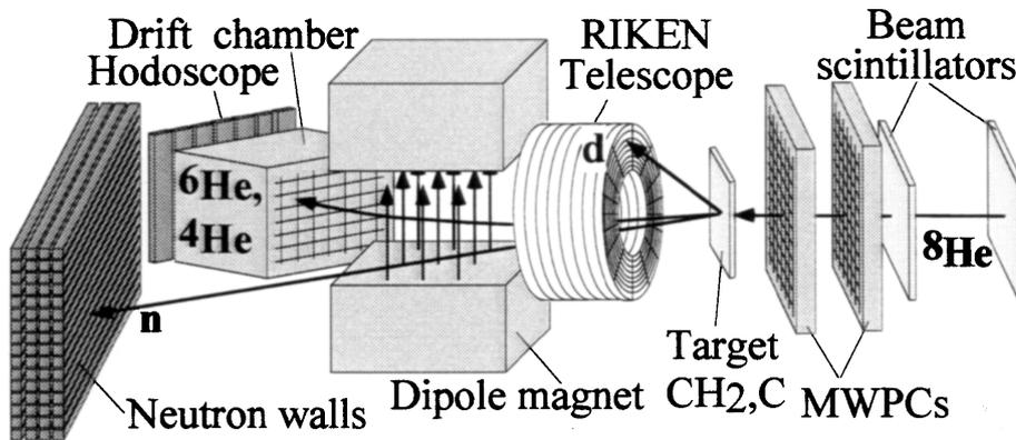
FIGURE 1.9 – Représentation schématique du dispositif expérimental de l'expérience de Korshennikov *et al.* pour la mesure par masse manquante de la réaction  ${}^8\text{He}(p, d){}^7\text{He}$ . Figure reproduite de la référence [27].
