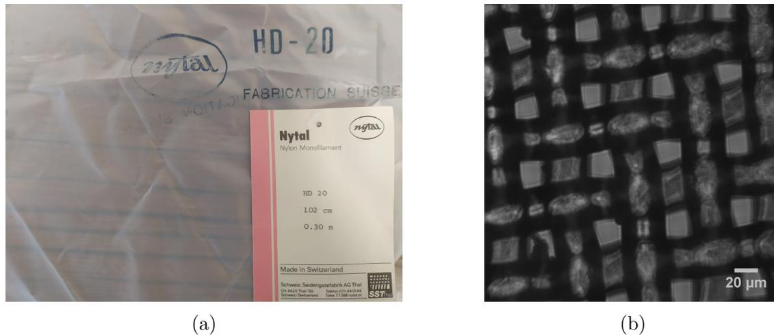
FIGURE 2.13 – a) Tamis en nylon (Nyltal) d'un diamètre de maille faisant  $20 \mu\text{m}$ . b) Image microscope d'un tamis en nylon ; focus sur quelques mailles de  $16 \mu\text{m}$  de diamètre
