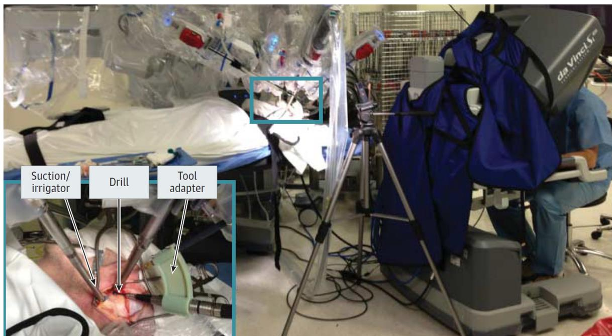
Figure 2.9 – Robot de téléopération da Vinci Si<sup>®</sup> pour l'implantation cochléaire (Liu *et al.*, 2014).
