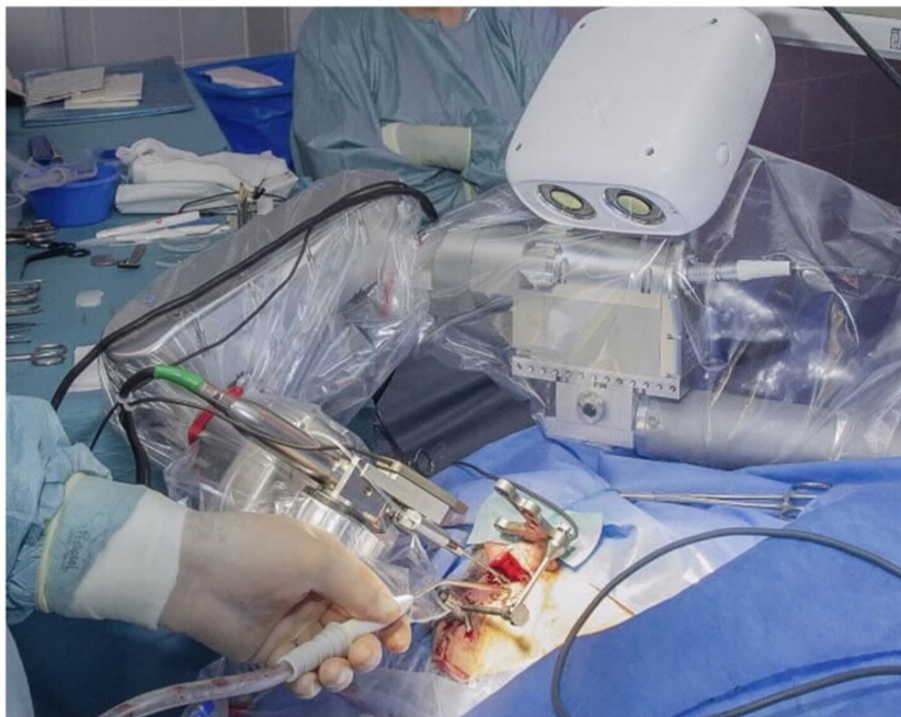
Figure 2.7 – Robot chirurgical HEARO ® utilisé en salle d'opération pour le fraisage de l'accès à la caisse du tympan (Caversaccio et al., 2019).
