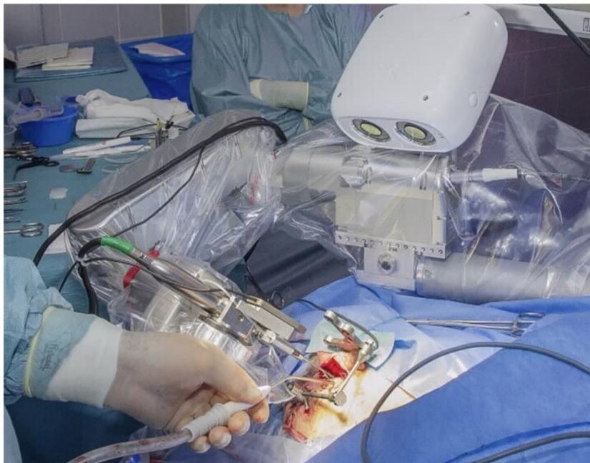
**Figure 2.7** – Robot chirurgical HEARO<sup>®</sup> utilisé en salle d'opération pour le fraisage de l'accès à la caisse du tympan (Caversaccio et al., 2019).
