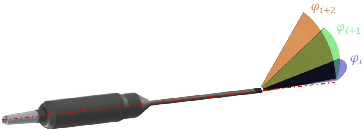
Figure 4.5 – Illustration du balayage en rotation de la sonde pour l'acquisition de coupes échographiques selon différentes orientations \varphi_i , \varphi_{i+1} et \varphi_{i+2} .
