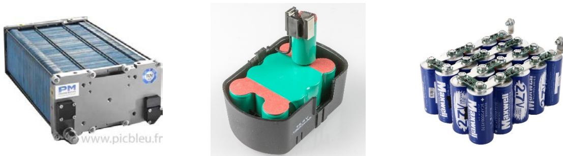
Fig. 1. De gauche à droite : pile à combustible, batterie d'accumulateurs et batterie de supercondensateurs
