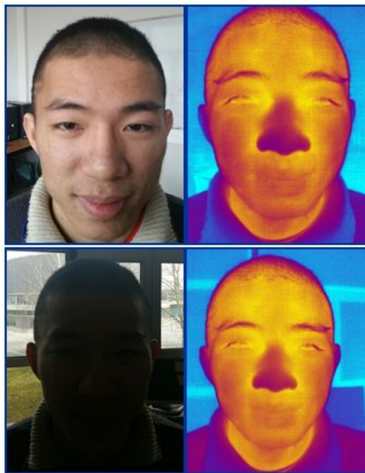
FIGURE A.11: Les images thermiques ne sont pas sensibles à la condition d'illumination
