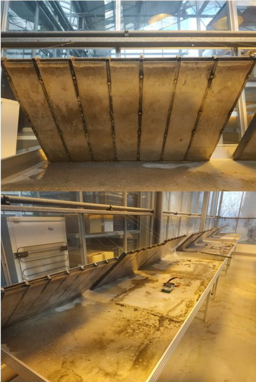
Annexe 3 : Rhizotrons en place (penché à 45°) pour l'expérimentation.
