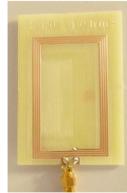
Réalisation de l'antenne sur PCB pour test et mesure
