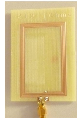
Réalisation de l'antenne sur PCB pour test et mesure
