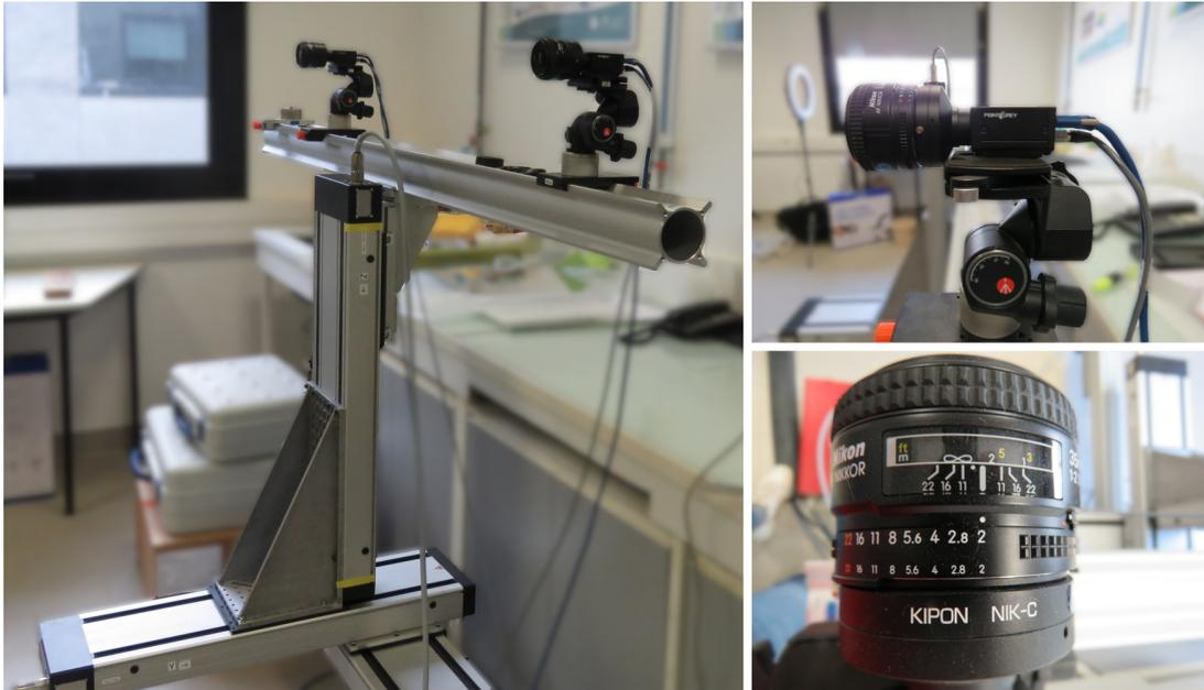
**Figure 3.23** – Système de visualisation du sillage interne et du bateau en vue de côté. Deux caméras positionnées sur des rotules 3 angles sont placées sur une table de déplacement ISEL 3 axes.
