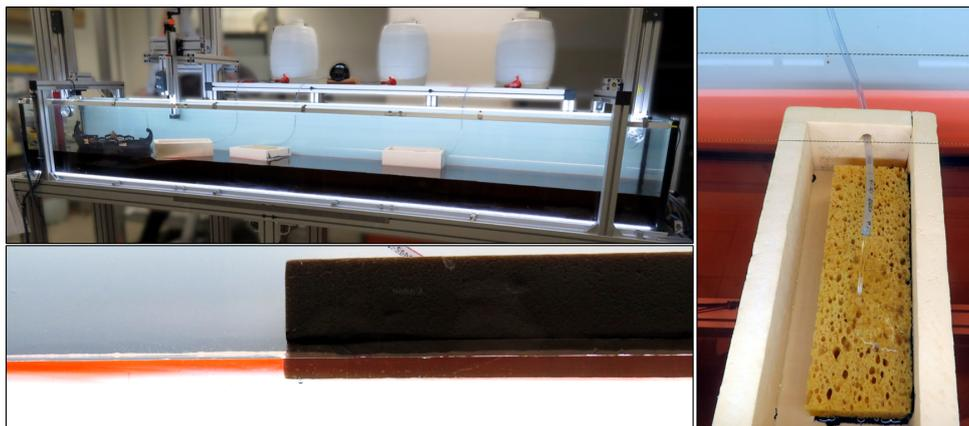
**Figure 3.19** – Mise en place d’une stratification à l’aide d’éponges. Les éponges flottant à la surface sont arrosées d’eau douce. L’eau se déverse alors sur la couche d’eau salée, les éponges permettant de limiter les courants verticaux. Pour mieux visualiser la mise en place de la stratification, l’eau douce a été ici colorée. Dans les expériences réalisées ensuite, c’est la couche inférieure salée qui est colorée.
