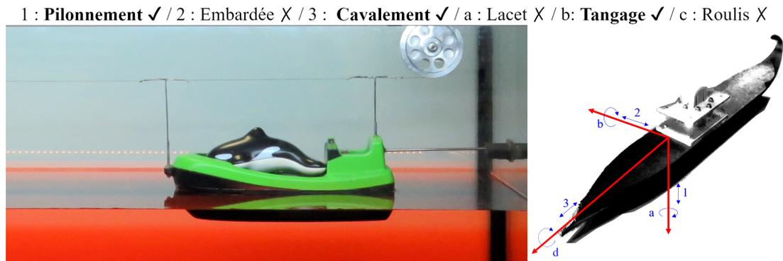
**Figure 3.22** – Système d'accroche du bateau à la proue et à la poupe. Les deux accroches en T permettent de limiter les mouvements du bateau au cavalemt (mouvement de sa course), pilonnement et tangage.
