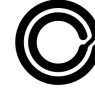
Figure 2.12 – Dessin de la ligne de transmission de la face supérieure du MTLR utilisé ( f_A = 104 MHz).
