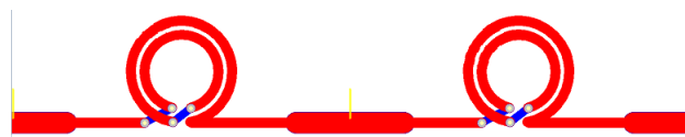
Figure 2.19 – Réalisation en circuit imprimé souple de la sonde de contrôle à double bobine.
