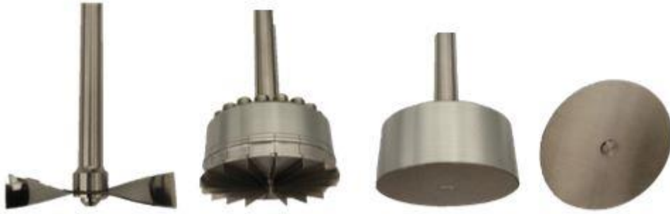
Figure 59 - Équipements du FT4. De gauche à droite : Hélice, tête de cisaillement, piston, disque rugueux.
