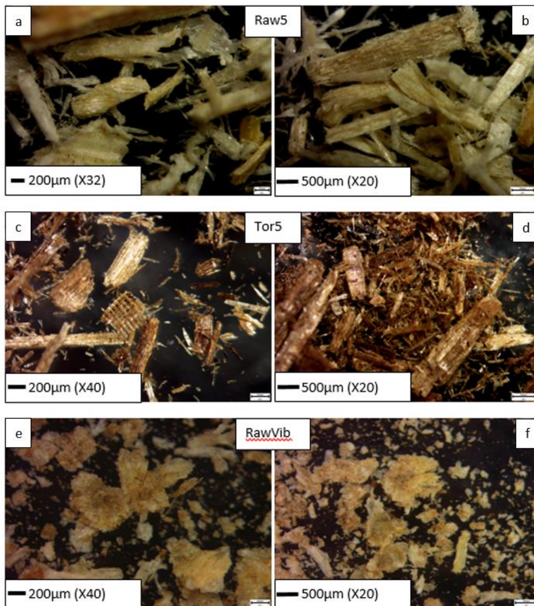
Figure 70 - Observations au stéréomicroscope des particules de bois. a-b : Raw5, c-d : Tor5, e-f : RawVib.
