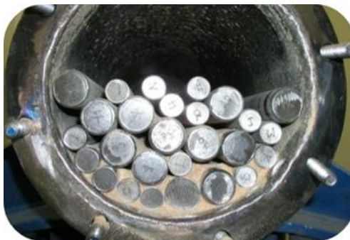
Figure 28 - Broyeur vibrant avec des barres d'aluminium.
