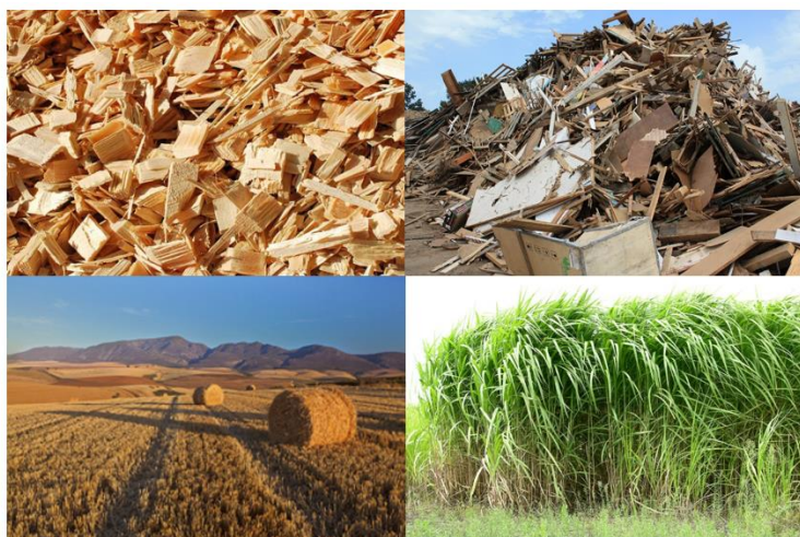
Figure 1 – Exemples de biomasses lignocellulosiques. De haut en bas et de gauche à droite : plaquettes de bois, bois B, paille de blé, miscanthus.
