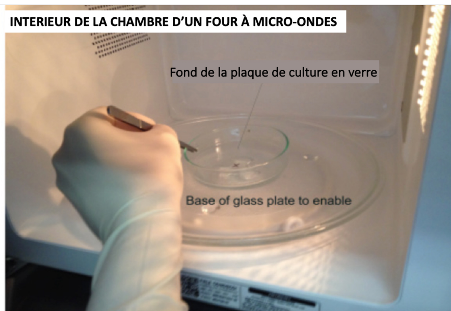
Figure 32. Brûlure in vitro par transfert de chaleur de la plaque en verre du four à micro-ondes à la plaque de culture en verre (Fernandes et al., 2014).
