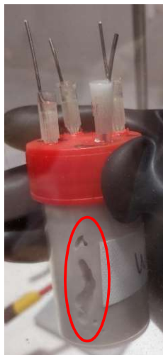
Figure 2-16 : Cavité formée autour de l'électrode de béryllium dans le ciment brushitique (WOL)
