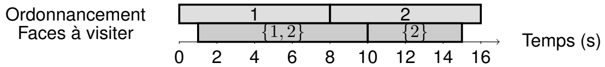
FIGURE 2.1 – Exemple d'un ordonnancement avec rayon de stabilité \rho = 1 s
