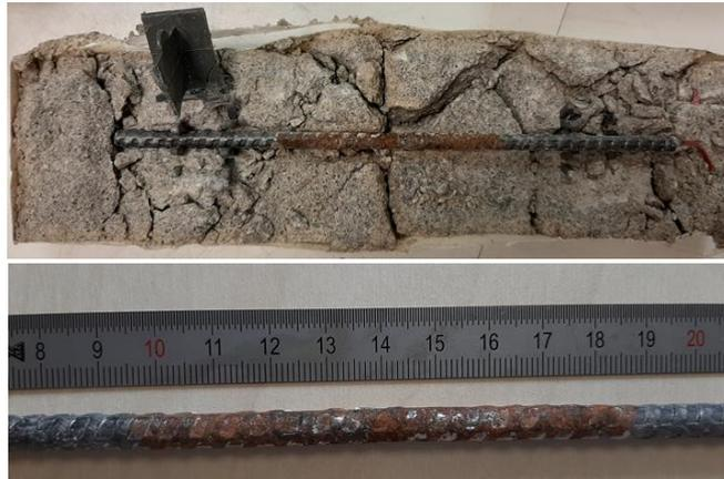
Figure 122 : Photos de l'inspection faite sur un échantillon destiné au suivi instantané de corrosion
