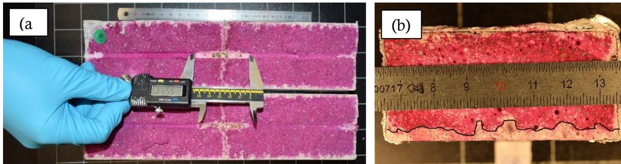
Figure 58 : (a) Longueur carbonatée à l'interface acier/mortier sur un échantillon fissuré ; (b) épaisseur carbonatée sur un échantillon non fissuré
