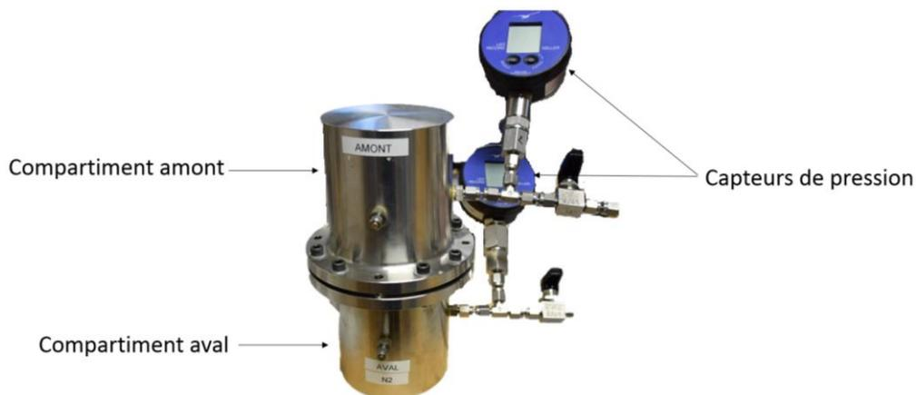
Figure 53 : Dispositif de l'essai de perméabilité au gaz
