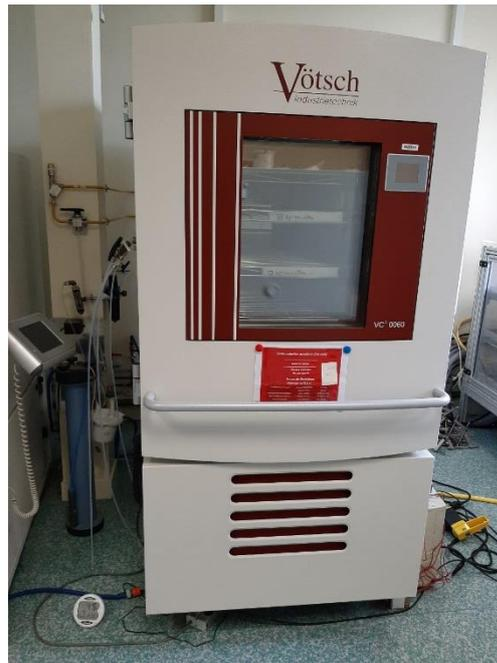
Figure 56 : Photo de l'enceinte climatique Vötsch VC 0060
