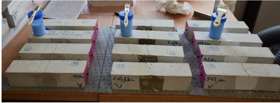
Figure 55 : Photo des échantillons lors de l'application des produits sur des échantillons prismatiques (fissurés)
