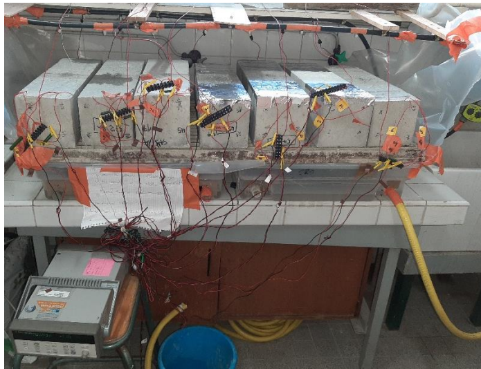
Figure 60 : Photo des poutrelles mises dans le dispositif de pluie/séchage au LMDC
