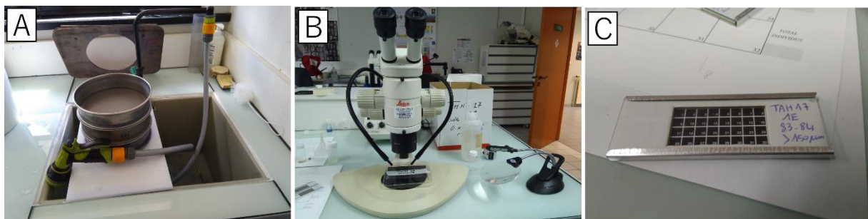
Figure III.14 - A : colonne de tamis (63, 125 et 150 µm) utilisée dans le lavage du sédiment. B : loupe Binoculaire pour le prélèvement des foraminifères contenus dans le sédiment. C : exemple de cellule de Chapman contenant des foraminifères.
