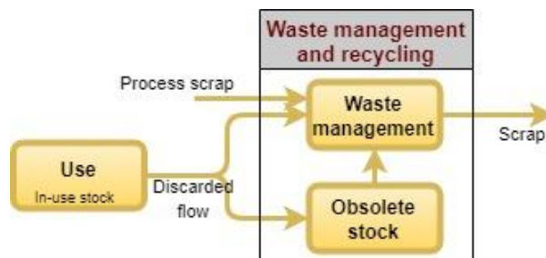
Figure E-3 Relation entre le stock en utilisation, le stock obsolète et le processus de la gestion des déchets et recyclage
