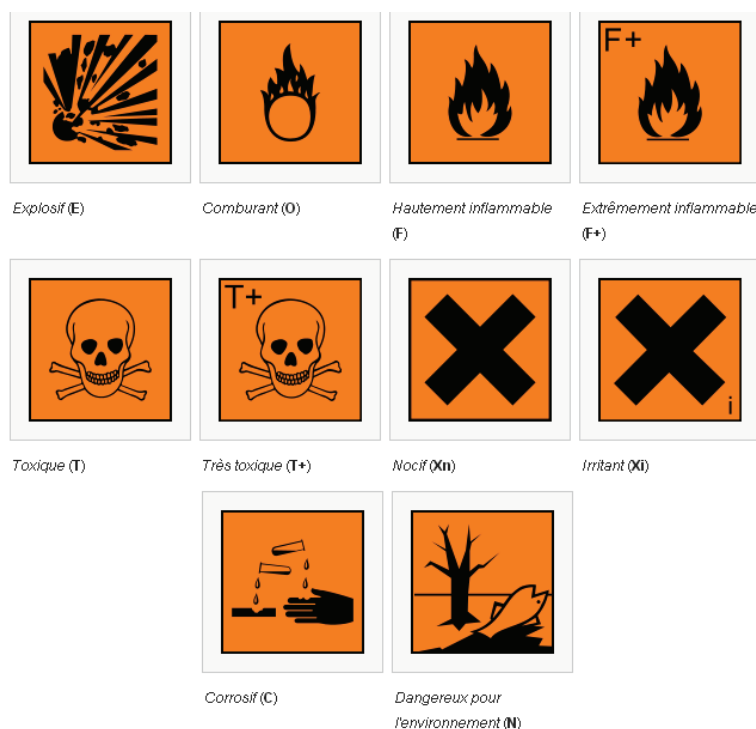
Fig. 1.4. Codification européenne des assemblages et substances dangereuses [WIK].
