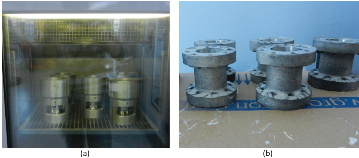
Fig. IV.25. Préparation d'éprouvettes TTC : (a) Cuisson au four dans les 5 dispositifs de collage et (b) Mouchetis noir et blanc.
