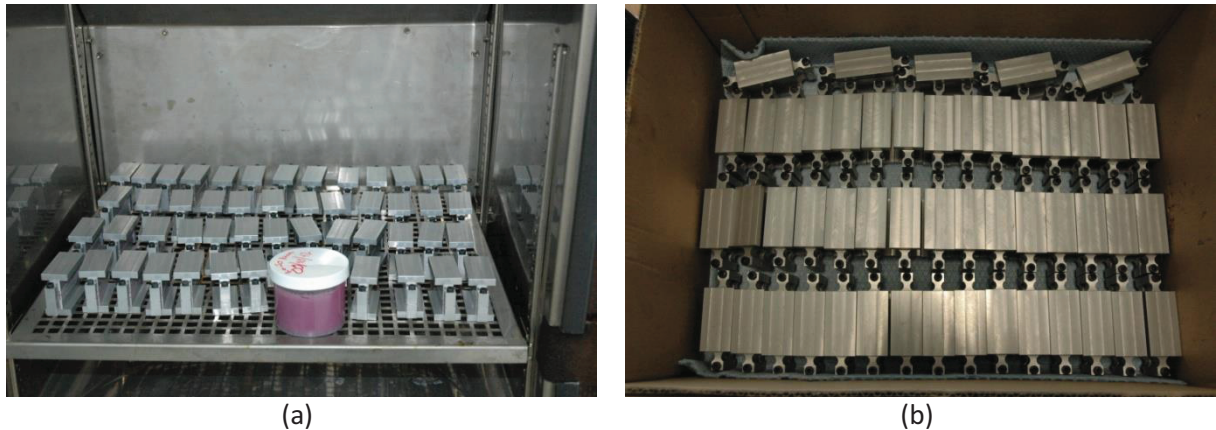
Fig. III.14. Eprouvettes Arcan modifié avant découpe des talons et avant vieillissement : (a) Cycle BT et (b) Cycle HT.
