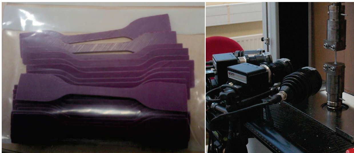
Fig. II.4. Traction sur éprouvettes massiques : (a) Eprouvettes manufacturées et (b) Essai de traction et dispositif de corrélation d'images.
