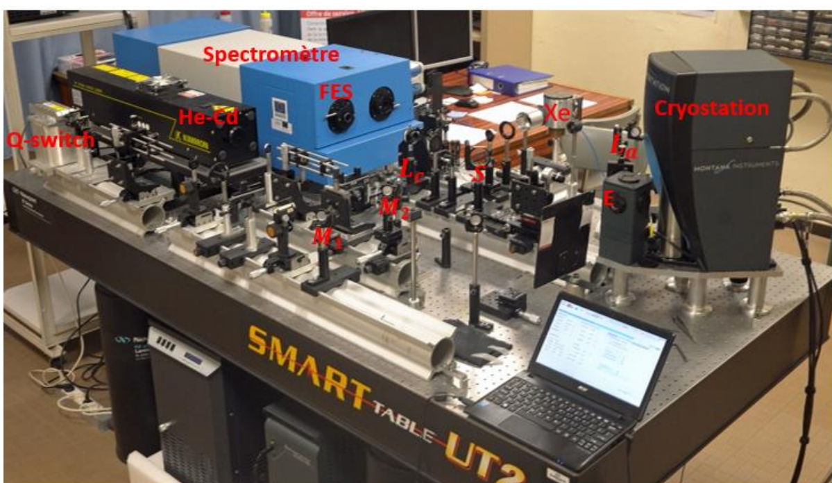
Figure II - 3. Photographie du banc optique avec les éléments optiques nommés en rouge : Q-Switched, He-Cd, spectromètre, FES (fente d'entrée du spectromètre), lentille de collecte ( L_c ), lentille asphérique ( L_a ), porte échantillon ( E ), fentes d'entrées du spectromètre ( FES ) et séparatrices M_1 , M_2 et S .
