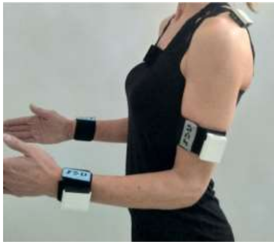
Figure 32 : Les capteurs MIMU sont portés au poignet, au bras, sur le relief de l'épine de la scapula et sur une épine vertébrale.
