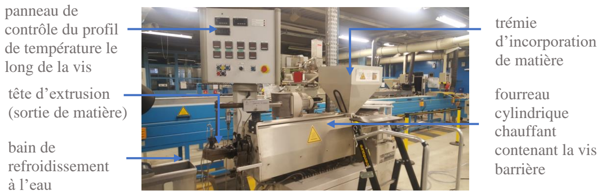
Figure 6 : Photo de l'extrudeuse Mapré utilisée.
