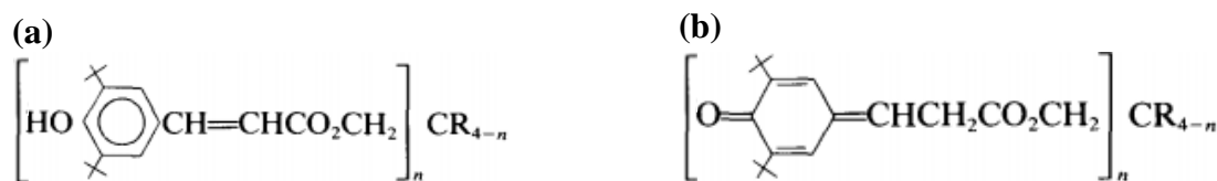
Figure P-4 : Structures des produits de dégradation d'anti-oxydants de type phénol encombré (Irganox 1010) : (a) cinnamate (b) quinone methide.
