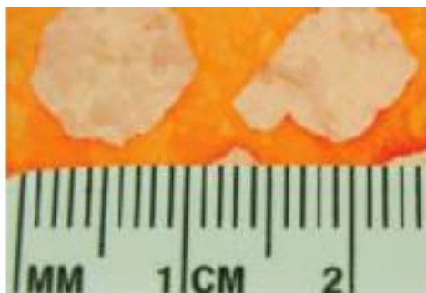
Figure I-14: Monocristaux de graphène de taille centimétrique synthétisés sur cuivre par méthode CVD. Les monocristaux de graphène ont une couleur beige [4]
