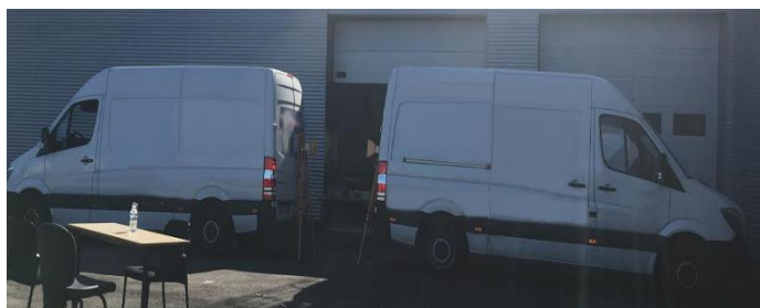
Figure III. 20: Antennes placées entre véhicules à h = 1.4 m.
