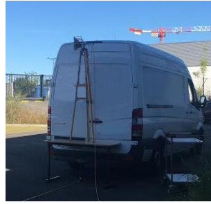
Figure III. 21: Antennes placées entre véhicules à h= 2.8 m.
