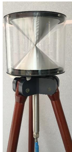
Figure II. 9: L'antenne biconique omnidirectionnelle de type RS0460.
