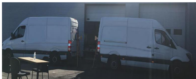
Figure III. 20: Antennes placées entre véhicules à h = 1.4 m.
