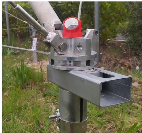
FIGURE 4.29 – Mesure de la position des appuis pour réglage.
