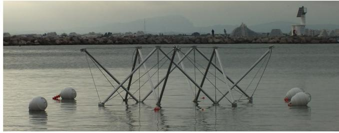
FIGURE 4.61 – Balisage par bouée du prototype.
