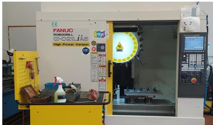
FIGURE 3.25 – Centre d'usinage ROBODRILL  $\alpha$ -D21LiA5.
