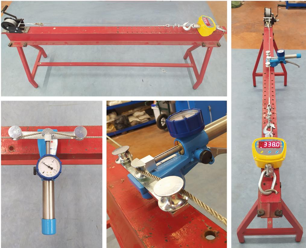
FIGURE 4.32 – Système d'étalonnage du tensiomètre en conditions Encastré-Encastré.
