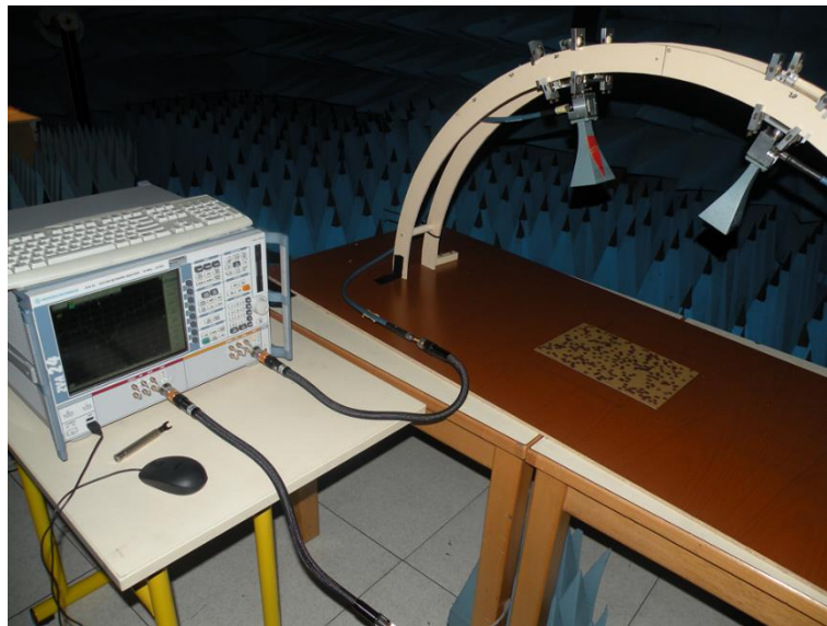
Figure 3.23 : Photo de la chambre anéchoïque incluant le dispositif de mesure composé des deux cornets attachés sur l'arche et reliés à l'analyseur de réseau.
