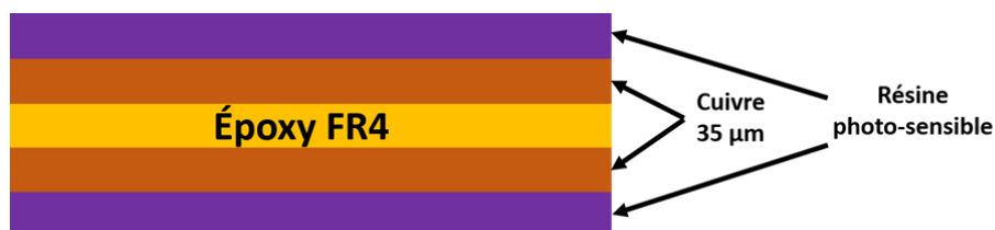
Figure 3.21 : Schéma d'une plaque double face servant à élaborer des circuits imprimés
