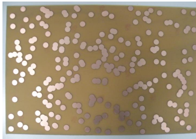
Figure 3.22 : Exemple de structure absorbante aléatoire réalisée par méthode de circuits imprimés.
