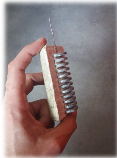
Figure 1.37 : Photographie d'une anode CC 100 dont une partie du mortier de pré-enrobage a été enlevée
