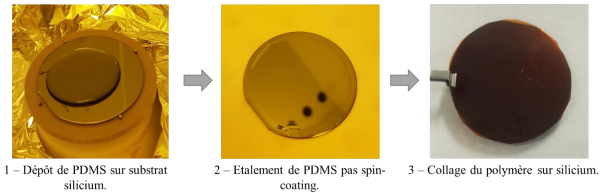
Figure II-7. Collage par PDMS.
