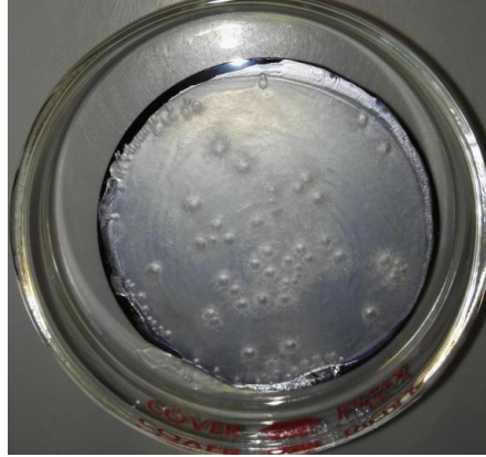
Figure II-4. Dépôt de biopolymère PLA par spin-coating en couche épaisse.
