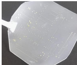
Figure II-14. Lignes filamenteuses métalliques (3-omega) sur un film épais de PLA.
